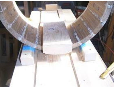
内面カーブに合わせ たブロックにペーパー をはり、内面研磨
