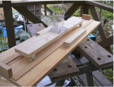
トリマーで内周を研 削するための治具を 製作
