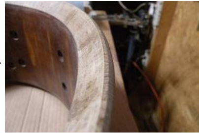
エッジ外面削り エッジ幅 1~1.5mm
