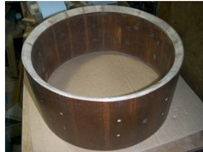
一段落 外径: 354mm 厚み: 17mm 高さ: 165mm
