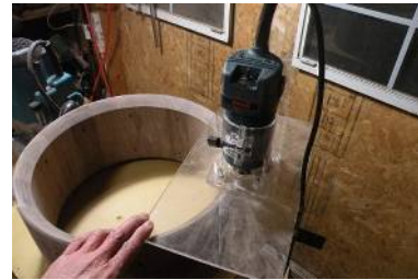
トリマーにアクリル板 ベースを取り付けて ベアリングエッジ外 側カット
