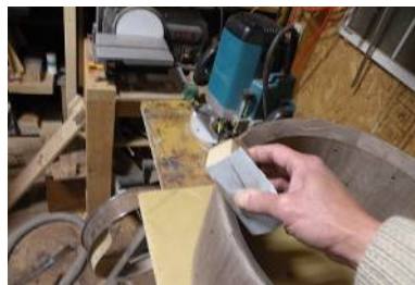
ベアリングエッジ幅 を均一にするため内 側45°面を研磨
