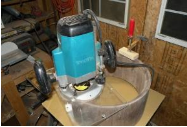
ルーターにアクリル 板ベースを取り付け てベアリングエッジ 内側カット
